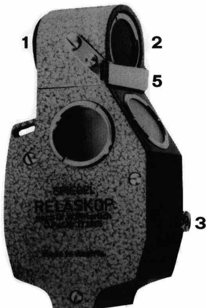
Fig.1 - Il relascopio a specchio:
